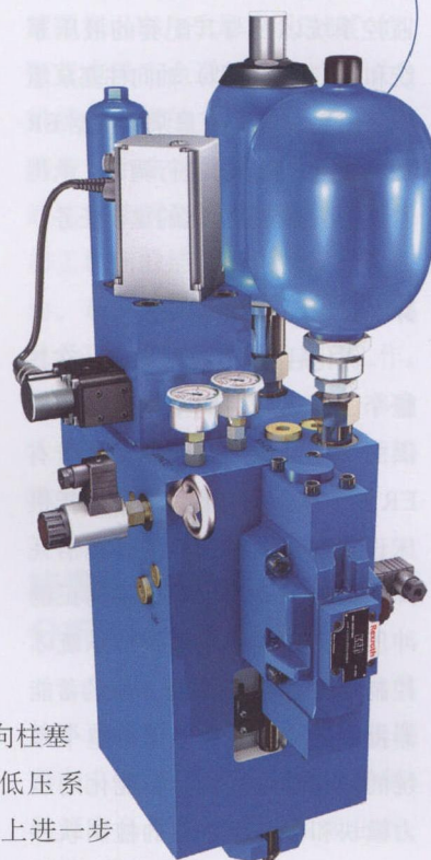
图 2 冲压模块主轴安装高效的液压缸可以实现 4000 次/min 的冲压频率
