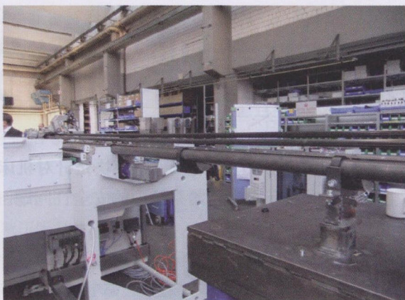
图2 滑台制作的非常细长, 没有驱动机构, 只有很少的几根电缆
