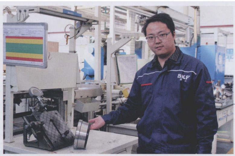
图 2 LIDKÖPING 磨床加工出的轮对轴承内圈
