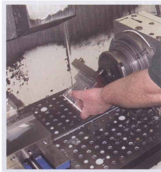
最后阶段是采用一套卡紧系统，使零件能快速装卡并精确定位
