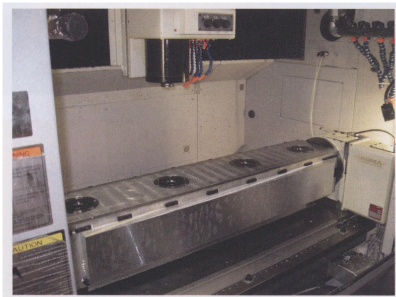
四个工件装卡在这套旋转式夹具的周围，每一个周期可分别加工两个工件上的 A 侧和两个工件上的 B 侧
