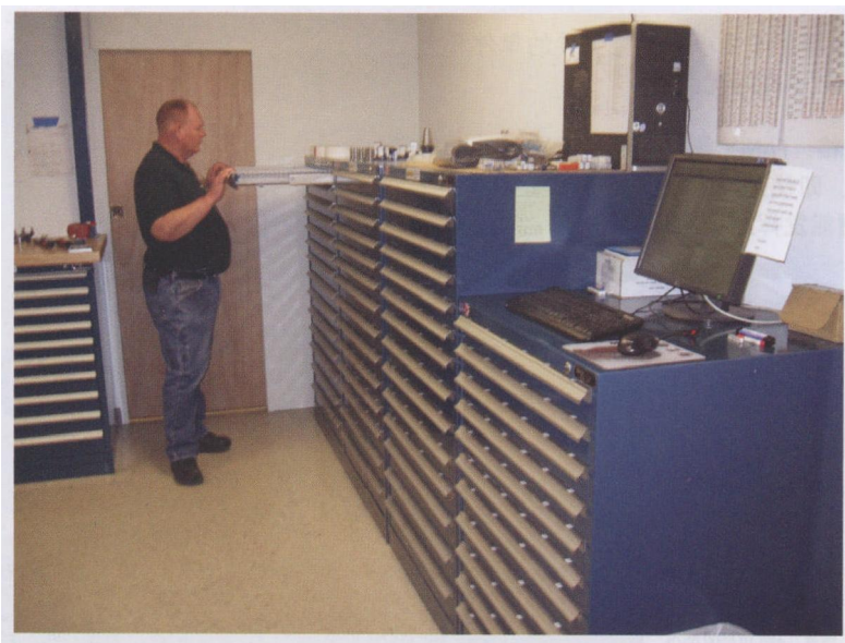
刀具通过该系统的软件解锁索取，该软件只能打开装有那把刀具的储存柜电子锁
