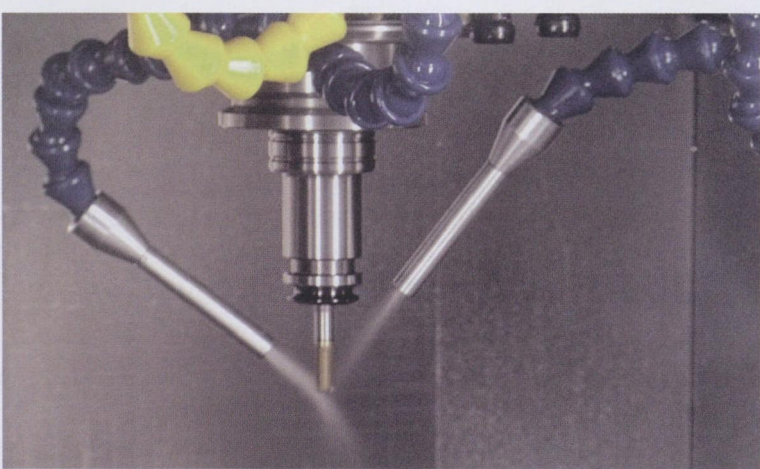
图 2 带有冷却剂的 IKZ 变型装置通过外部多个喷嘴将气溶胶干润滑剂导到正在进行切削加工作业的机床刀具上
