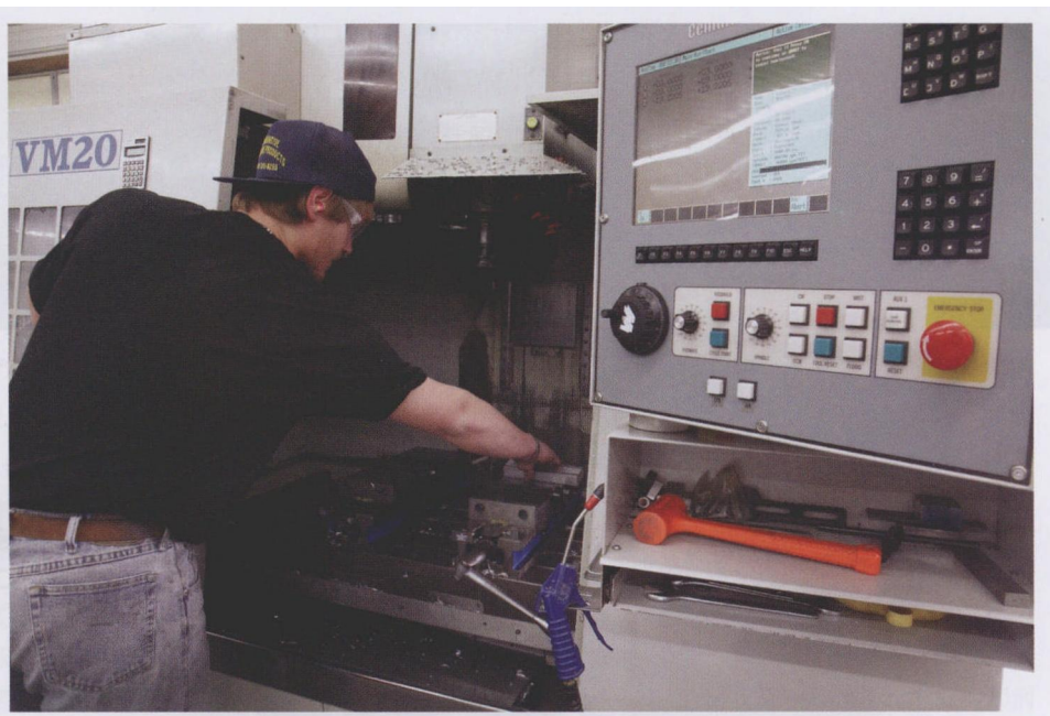
图1 虽然这台 VM20 型机床的配置范围有限，但它可以在几秒钟内迅速更换刀具，以便生产其他枪支的零件。该车间 Milltronics 公司的机床，具有很好的互换性，易于编程，工艺流程十分顺畅
