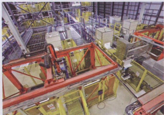
图2 ES3 托板处理系统设计通过量为每小时 74 个托盘共计 5530 个纸箱
