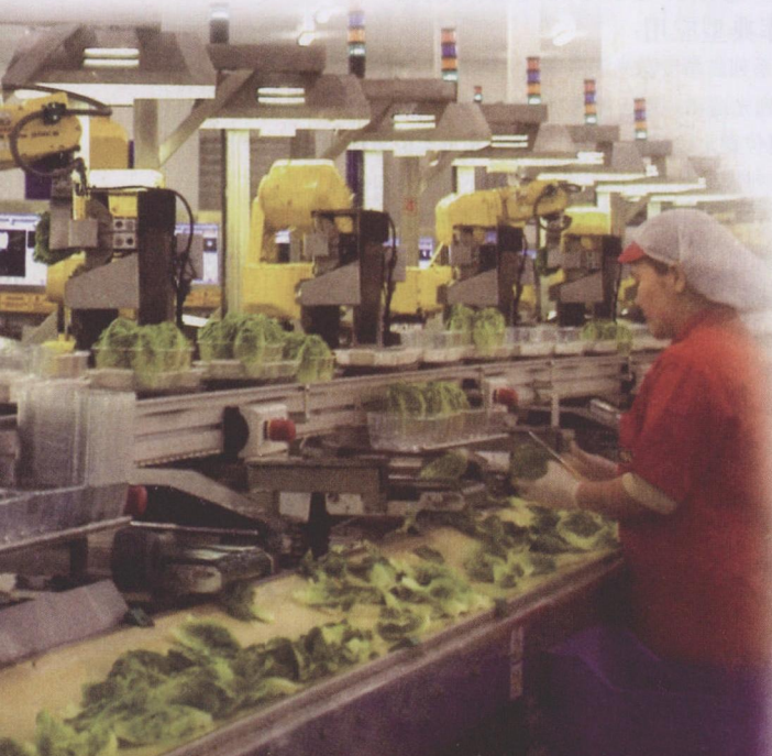
图 1 在最终检验结束后，莴苣菜被运到下一站，在那里被放置在塑料盒里，再经过传送带传送到包装站
