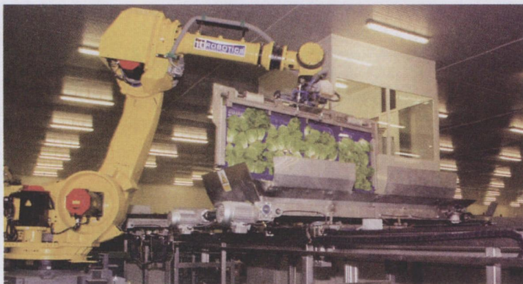
图2 莴苣菜放在塑料包装中装到托盘上, 交货后再由 Fanuc-R-2000iB 型机器人从包装中取出并放置在传送带上
