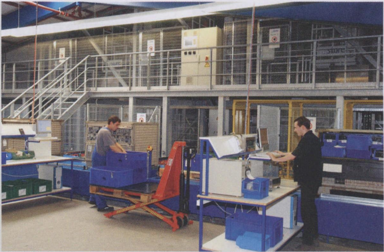
图5 物流经理 Volker Tichy 表示：“维世多系统的高架仓库可缩短仓库管理员来回走路路程并减少在制品库存量。仅仅是节约的面积，就可以赢回投资。”
