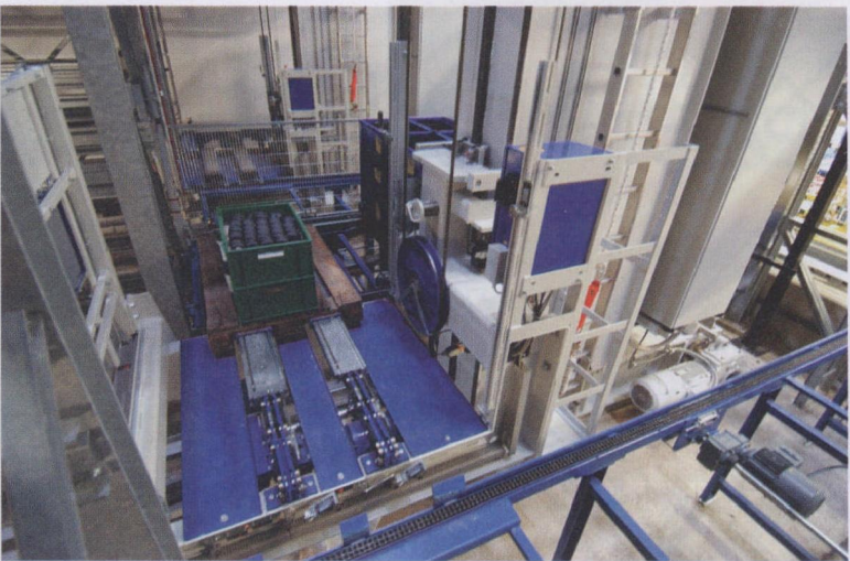
图4 存储与检索机 viapal 最多可以载重 10t，梅卡朗公司可以承载的托盘重量不能超过 1.1 t
