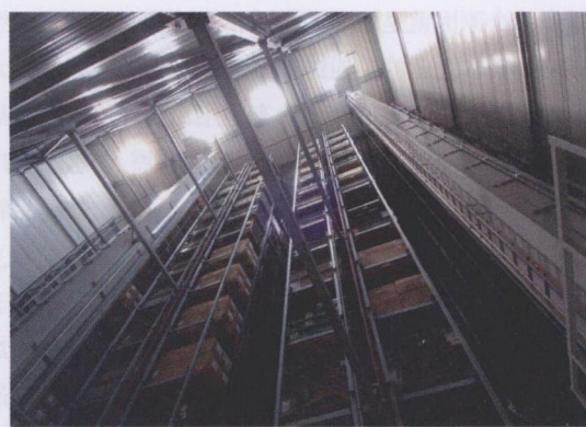
图2 高架仓库的四个通道中可以容纳 6000 多个欧标托盘或栅格盒装托盘
