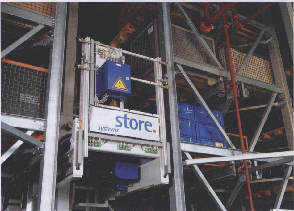
图3 存储与检索机 viapal 利用减震行驶曲线进行动态行驶，最快行驶速度可以达到 240 m/min
