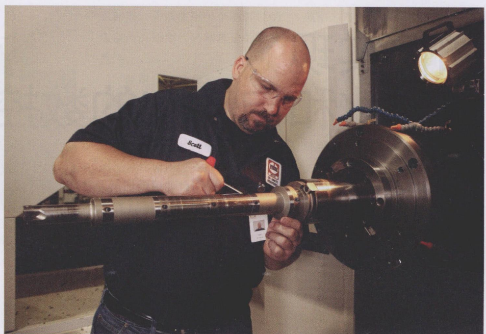
图 3 RML 公司首席机械师 Scott St. Denis 先生正在组装 Ingersoll Inno-Fit 刀具的延伸轴, 为了保证其刚性, 延伸轴上设有三个接触点, 采用自定心设计, 在配合面上带有很大的接触面积
