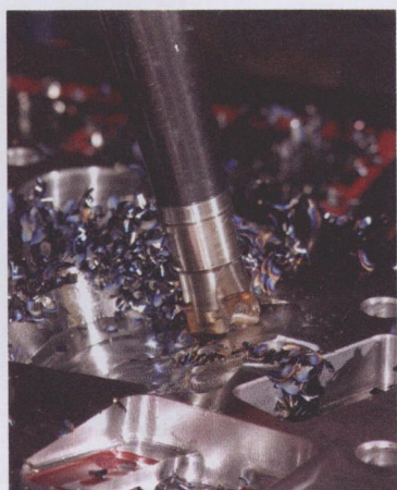
图1 Ingersoll 公司的 Hi-FeedMini 铣刀正在对 CME 公司的一个模腔进行半粗加工，在淬火的 P20 模具钢上加工时，0.25~1 in 长的刀具进给速度为 199 in/min
