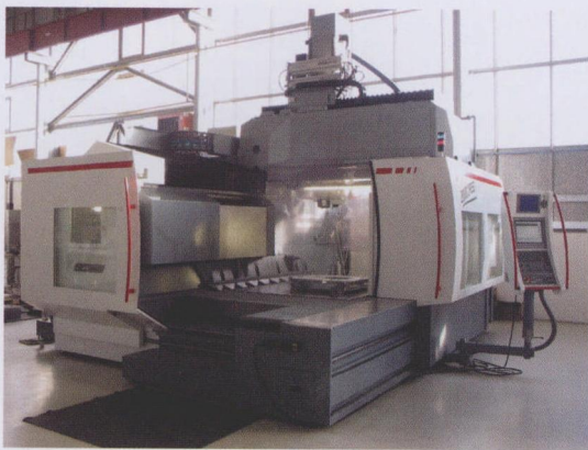
图2 数据被传送到该机床后,所有刀具将在激光测试仪中用TEST 测试程序进行自动测量,确保它们符合所要求的(编程)公差和处于换刀系统中的正确位置
