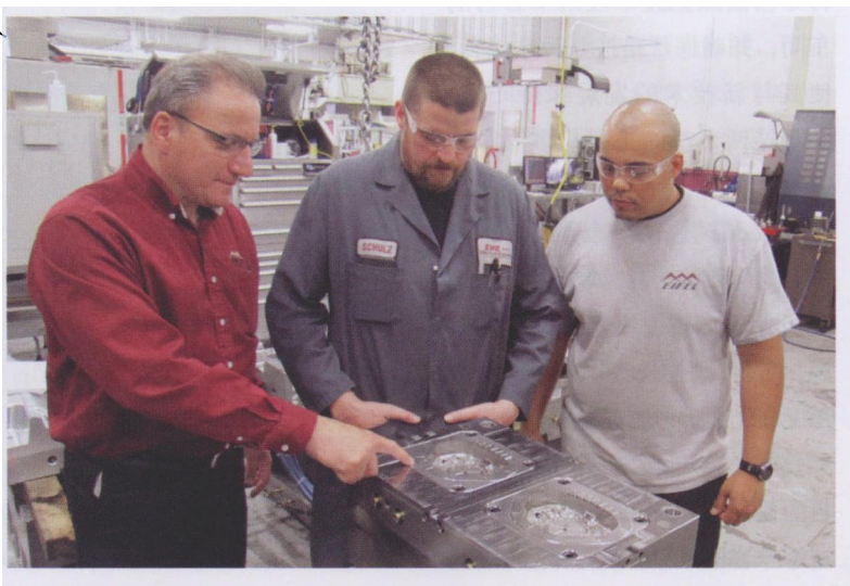
图 4 Rick Hecker 先生、Gary Schulz 先生和 Brainda Johson 先生正在检查一个安全气囊保持器外壳的模具，这个模具是由 H13 号模具钢在淬火状态下切削加工而成的，其完工后不需要经过手工打磨或逐点打磨
