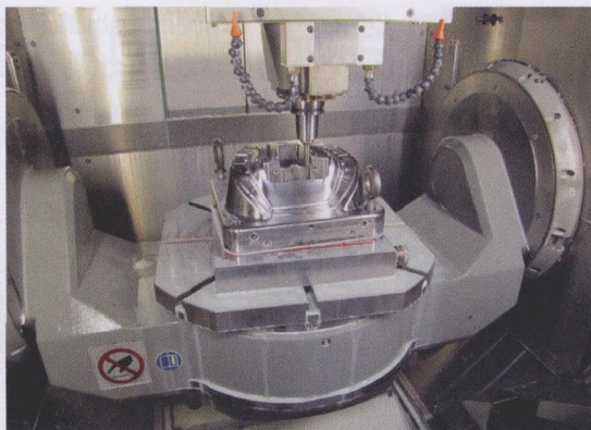
图 2 这个方向盘模具型腔的近视图可显示出其加工时的表面质量，按照“模型”进行零余量加工，需要机床、刀具组装件和 CAM 编程具有极高的精度
