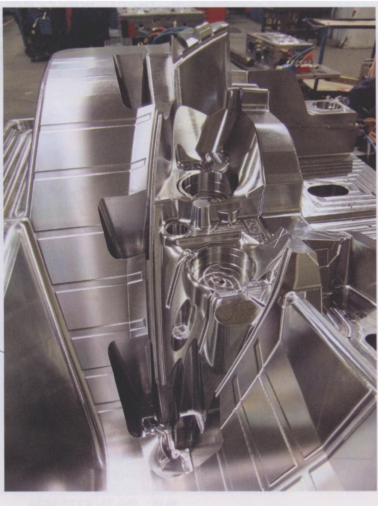
图 1 零裕量加工 的实践，适用于 大型、复杂模具 的元件，例如图 中 Redoe 公司生 产的这种汽车尾 灯模具的型芯
