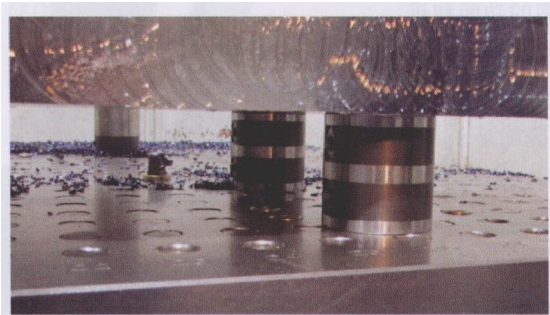
图 6 由 FCS System 公司提供的一套以网络为基础的精密夹具系统，可以让 Redoe 公司将大型模具基座从一台机床上迁移到另一台机床上，不需要建立指定的位置，带定位销的立柱与每台机床上安装的基板网络模型孔接口连接
