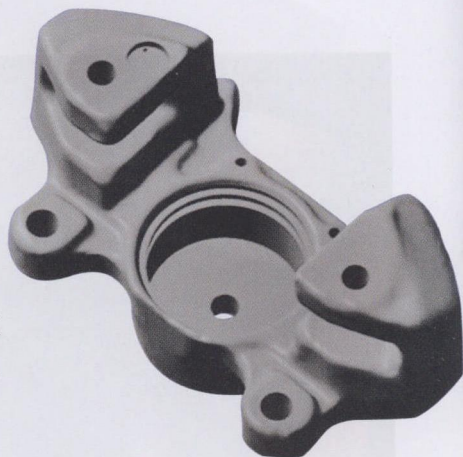
图 2 Geomagic Studio 软件可以让 EADS 将扫描点云数据转换成一个 3D 数字多边形表面模型, 用于最终的添加生产工艺之中
