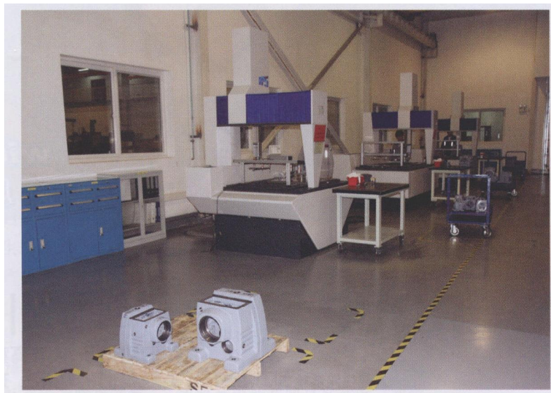
图中为正在服役的三台蔡司三坐标测量机正在紧张工作中，前面地上放工件的空出的位置是为即将于 5 月份到位的另一台蔡司三坐标测量机预留的。
