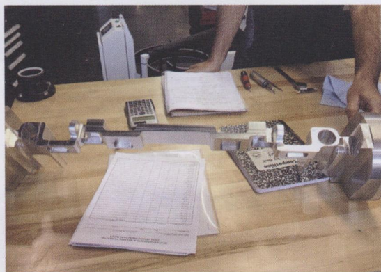
图4除了需要切断之外，这已经是一个即将完工的成品。在零件每一端以一定角度钻削加工的孔径，其相互之间的位置必须非常精确，在任何其他类型的机床上加工生产这个零件，是很难满足这一加工精度要求的
