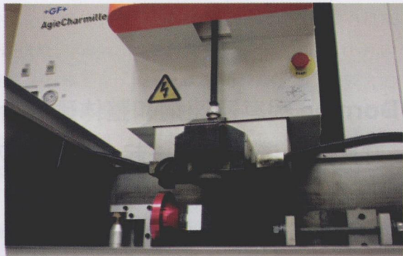
图 2 燕尾槽夹具的定位销重复精度达 0.001 in，使得该车间的零件能够在不同的机床之间无缝移动
