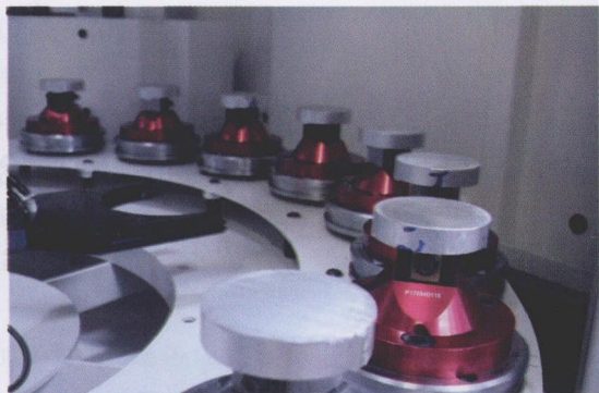
图 1 5th Axis 公司约有 90% 的工件采用其内部设计的燕尾槽工装夹具
