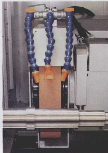
图3 OGM III 系列磨床使难加工的现代磨料得到了充分的利用
