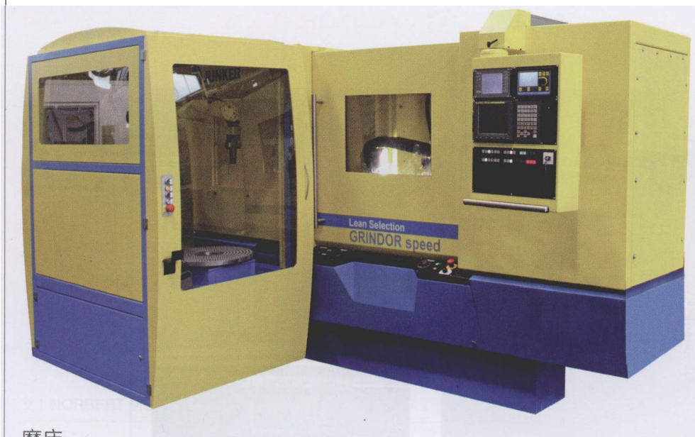
图1 ZPS 公司采用 Erwin Junker 公司的 lean Selection Speed 高速磨床取代了之前使用的外圆磨床
