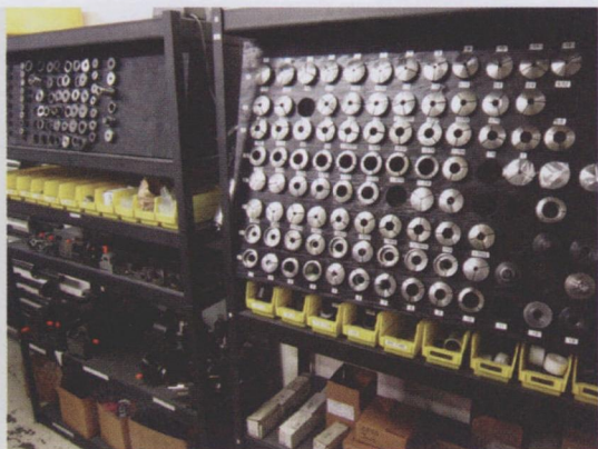
图 4 Pro CNC 公司车削加工车间的工人们开发了这套系统，与以前使用的夹套储存架相比较，这套储存系统使夹套的识别更为容易
