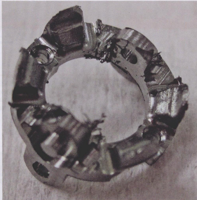
图3 机加工所面临的挑战之一是打毛刺工艺。采用添加法生产的每一个链接环，无需去毛刺
