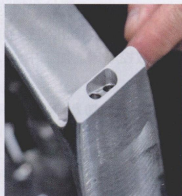
图 3 薄壁结构需要极高加工精度
