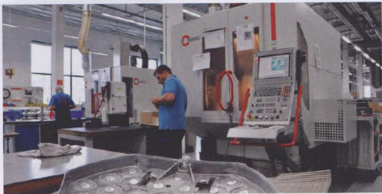
图4一次装卡完成该铸件加工
