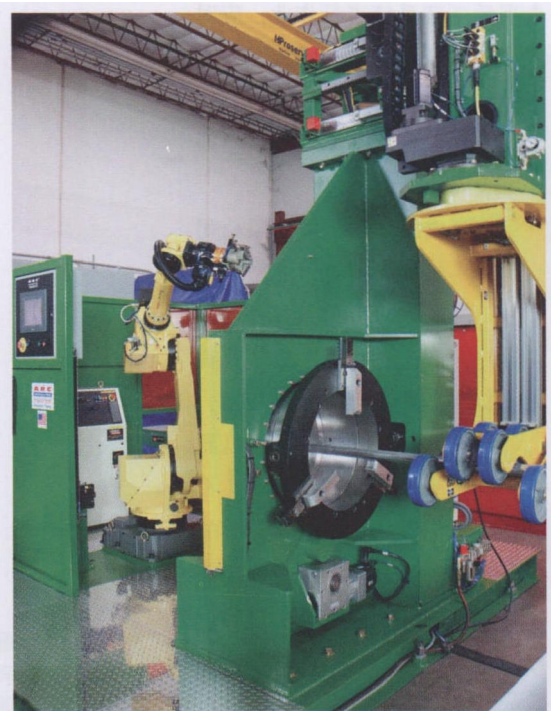
图 1 ARC-11-RB 型焊接机器人是一台用于组装和液体清洗设备的自动化焊接机器人
