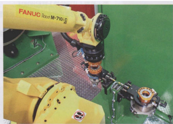
图 7 FANUC 公司 Arcmate M 710i C-50 型机器人由 Beckhoff 公司 CX1010 型嵌入式 PC 进行控制
