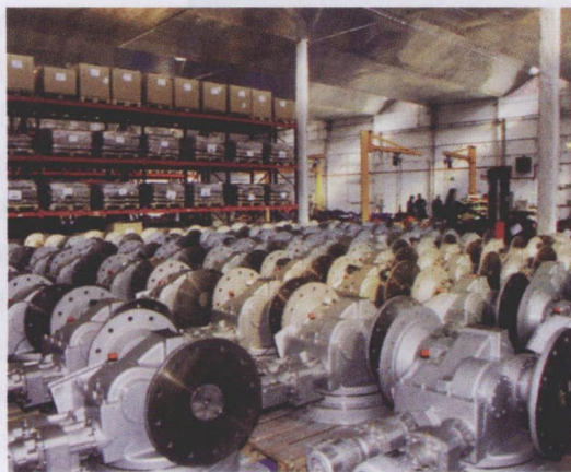
每台坚固耐用的齿轮减速电动机保障了巨大的聚光镜沿两个轴线方向的精确跟踪定位
