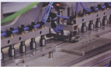
完美的钎焊准备工作：真空吸盘把一个接片作为一个整体放置到太阳能组件上
