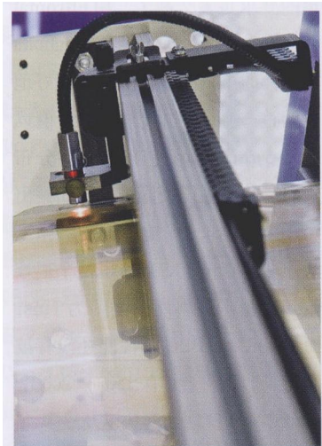
图 2 自适应 RGB 套色标记传感器以极高的精度工作，且符合光学 Ex 认证
