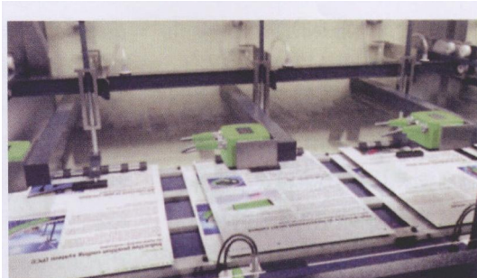
纸张缺陷识别：这里，整理机使用的是 BIS510 型视觉传感器
