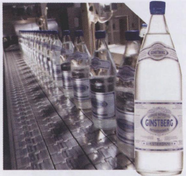
玻璃瓶装的瓶装水产品应用了喷墨打印方案实现了产品的可追溯目标。
