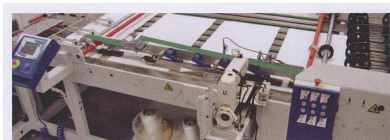
图3 织物被送入系统进行切割、折叠、缝合并装载
