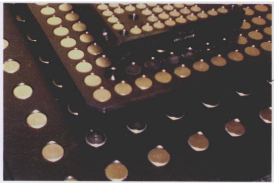
图2 由于有许多不同尺寸的网格板可供选用，该系统具有足够的灵活性，可涵盖任何尺寸工件
