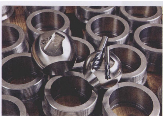
图 2 一把 Imco 公司的 Everyday Advantage 立铣刀，除了加工两个图中所示的铬镍铁合金零件之外，又多加工了 12 个由 4140 号不锈钢制成的零件，且刀具完好无损
