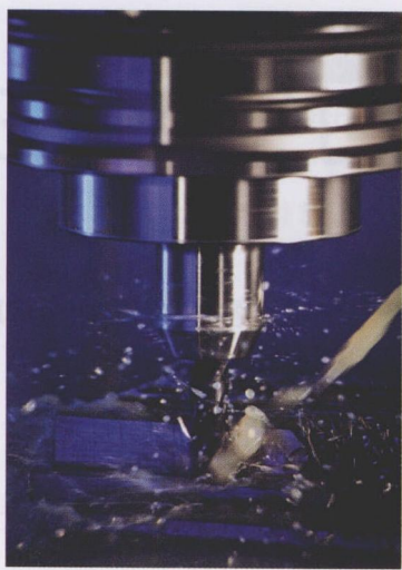
图 3 在 Kline Oilfield Equipment 公司取得成功之后，Imco 公司也在其自己的工厂内对铬镍铁合金进行了一些切削加工试验，从图中可以看到，该公司的其中一把 E-14 型通用立铣刀正在对难加工材料进行铣削加工
