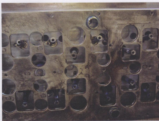
图3 这是通过夹板（左图）原理实现可接近性的一个实例，所有这些升降杆的顶端都带有攻丝螺纹，可通过夹板接近（右图）
