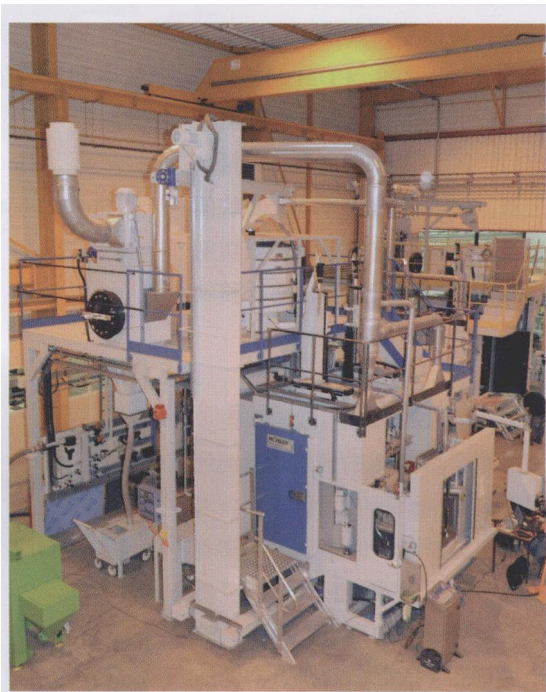
该喷丸强化设备可以同时十个不同的传动件用两种不同的钢丸进行表面硬化处理
