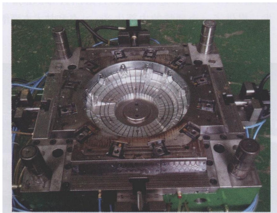
图1 由高强度铝合金制成的洗衣机筒成型模具
