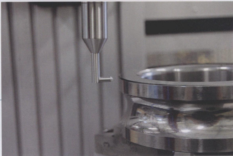
图 3 采用涡流检验法使用的检验试探器
