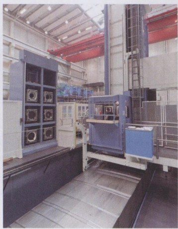
图3 接收站设有八个接收辅助刀组的工位
