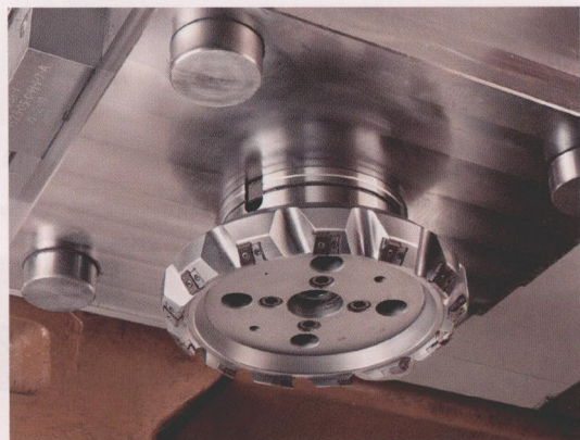
图3 采用龙门铣床主轴进行加工
