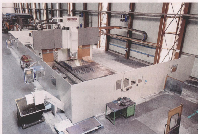
图1 位于工具钢供应商即Kontur公司大厅里的PFSG100型龙门铣床
