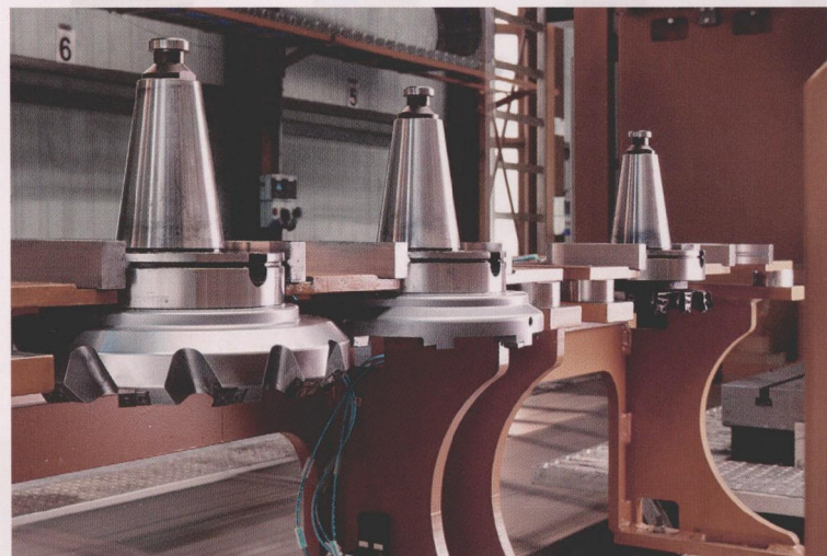
图2 SK50或SK60规格的刀具的摆放处
