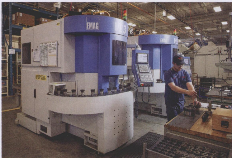
图1 每一台VL系列机床都配有一条传送带和一根主轴，可以像其自身的加工单元那样工作。ODG公司的Mark Diefenbaker测量装置用于测量其Argo ATV车辆变速器上的孔径
