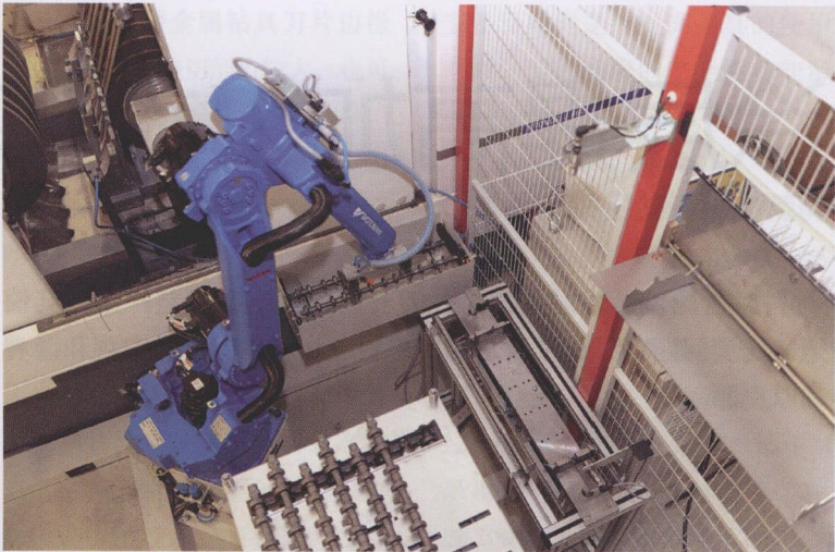
图 4 两个机器人工作站集成了精密和耐脏的动压测量装置，保证了质量。
