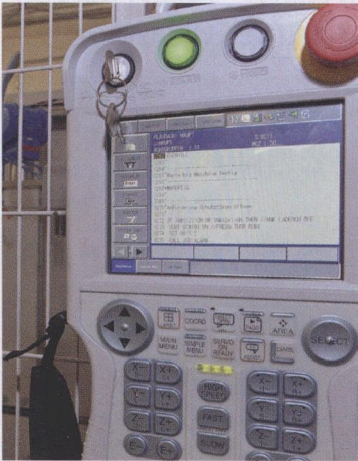
图 3 用于 Motoman 机器人的 DX100 型便携式可编程装置，具有紧凑、轻型、舒适的特点。
