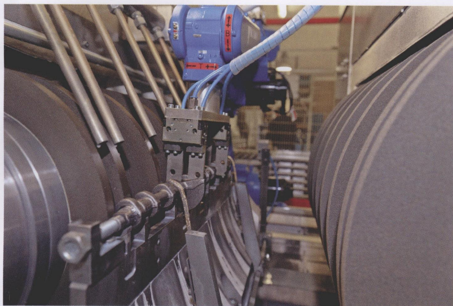
Unirobot 是一种模块化的机床自动化系统。机器人对外圆磨床进行装载和卸载
