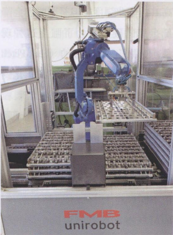
图 2 稳定存取 8~10 个偏心轴的工件存取托盘是两个 Unirobot 自动化工作站的显著特征
