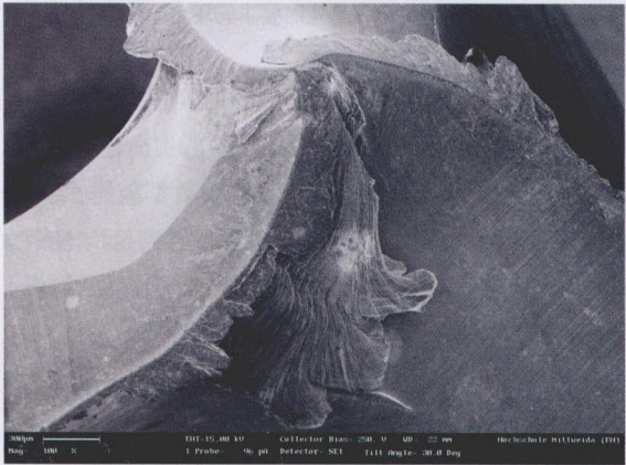
图4 在经过 200 次钻孔之后，未涂层的 K10 VHM 转位钻刀上所出现的刀瘤
