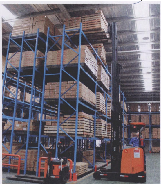
图4 叉车上统一贴有反光条,提高了操作安全性
