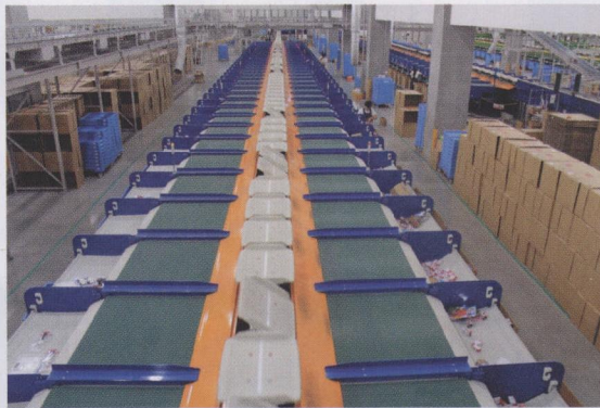
图 2 单品分拣机日均可处理 35 万件产品。共设有 300 个滑道 (150 × 2 条线), 分别为不同的店铺分拣产品
