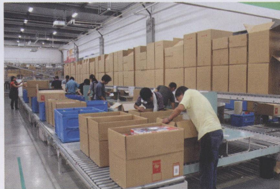
图 4 出货区——利用传送带式分拣机, 将产品按照不同的运送公司分类并出货
