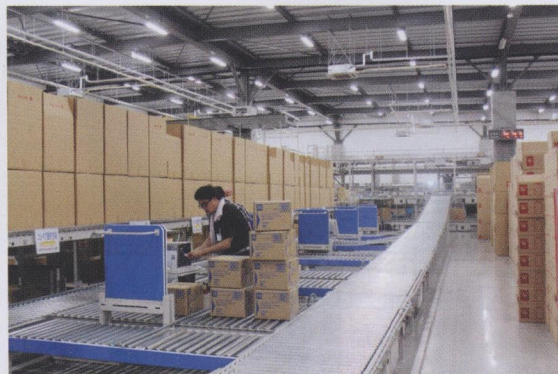
图 3 捆包区——按照店铺的不同, 分别将产品投入不同的纸箱, 并在纸箱上贴标签
