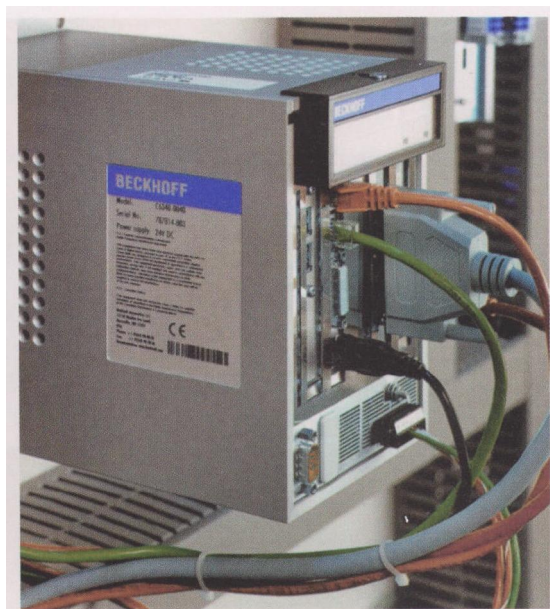
图 4 控制系统的核心部分是一台 Beckhoff 的工业 PC C6340，它采用的是 Intel®Pentium®M 1.8 GHz 处理器
