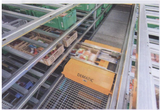
图 1 德马泰克多层穿梭车系统驱动的新型拆零货到人订单拣选解决方案
