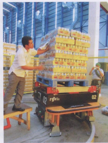
图 2 采用有轨小车，货箱运送安全又快捷
