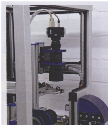
图 1 一个集成化的线性加速装置为被检巧克力加速，仅仅将其推进几厘米，目的是该巧克力随后以固定速度在两台行扫描相机下贯穿移动
