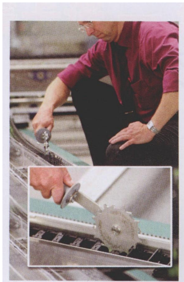
图2 能源托链在1.3 s内可运行1 m: Uniflex 系列 Advanced 系列能源托链有可掀开的滑块受电器, 这是 Tsubaki Kableschlepp 公司提供的具有革新意义的用于快速打开滑块受电器的工具
