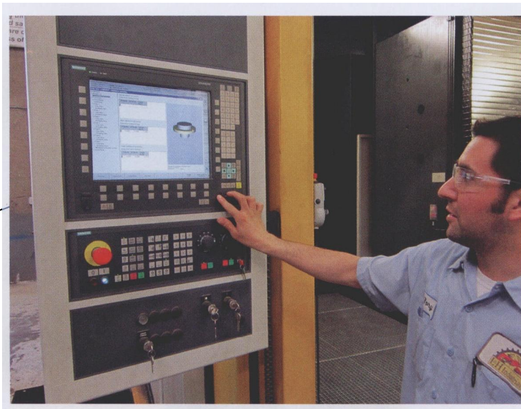
图4 工程师 Rory Tagle 正在工件模型上设计一个模拟圆筒表面形状, 以防止磨轮进给到这个区域
