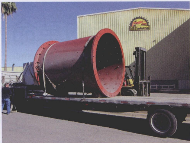
图6 这个用于铁矿和铜矿生产的球磨机外壳体现了 Tempe 工厂所执行大型机加工作业, 该部件的两端都将在工厂的立式转塔车床上进行表面加工
