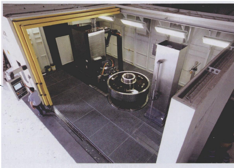
图3 这台 5 轴 Höfler Rapid 6000 型仿形磨床的工作台能够在静压轴承上沿轴向和径向运动
