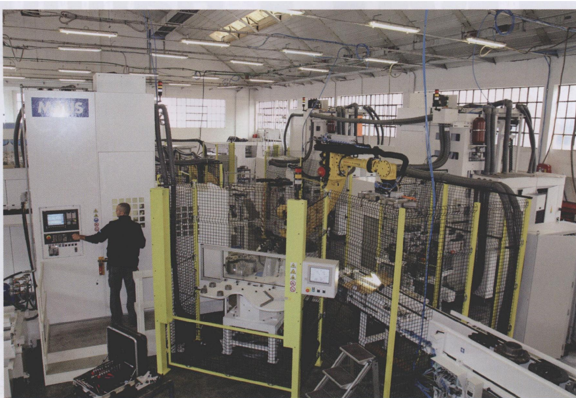
图 1 该柔性加工单元由 3 台 MTV 5 型装有总体自动化装置的立式车床组成
