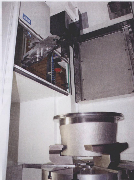
图 2 柔性车床可自动更换刀具的腔体
