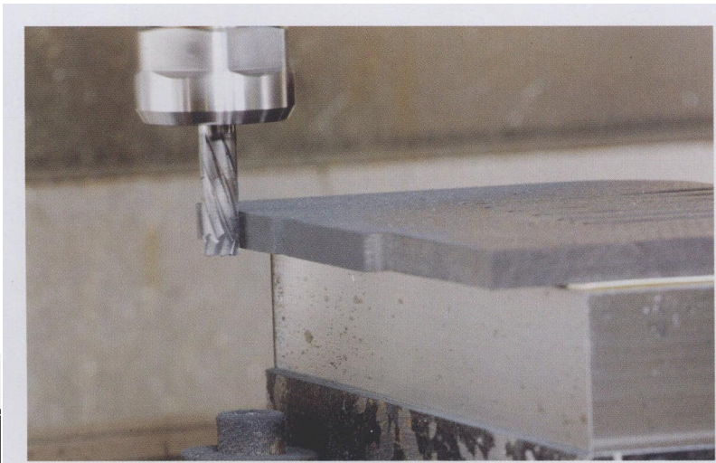
图3 双螺旋 Dura 镀层的精铣刀 JC840
