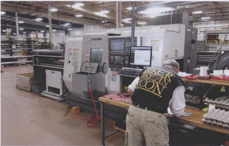
图 5 这台 Okuma LM 车削中心配备了双主轴和双转盘，并具有实时工具切换功能，可年产 5 万件越野车的悬挂部件
