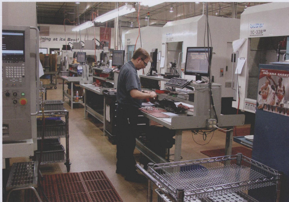
图4 每一台 CNC 机床上的计算机站都可为操作者提供功能强大、内部编程的 ERP 系统的访问权限和他们所需要的全部信息。这套系统本质上体现出来的充分灵活性让该公司能够进行改造来满足不断变化的需要
