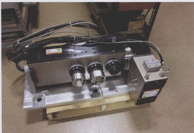
图3 这种向5轴机加工的转变促使了企业在编程工作进行思维方式的转变。目前编程员已经可以将A轴转台的中心线指定为共用的零点位置,从而在转台旋转时,此零点位置不会改变
